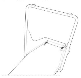
Etwas zu locker am Brett? Durch leichtes biegen der Lasche zur Innenseite kann das Einrasten verbessert werden!
